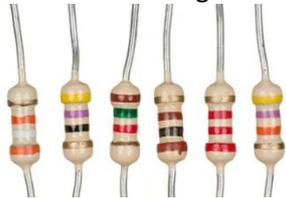
Resposta: Resistor, que é um dispositivo elétrico com alta resistência elétrica.
